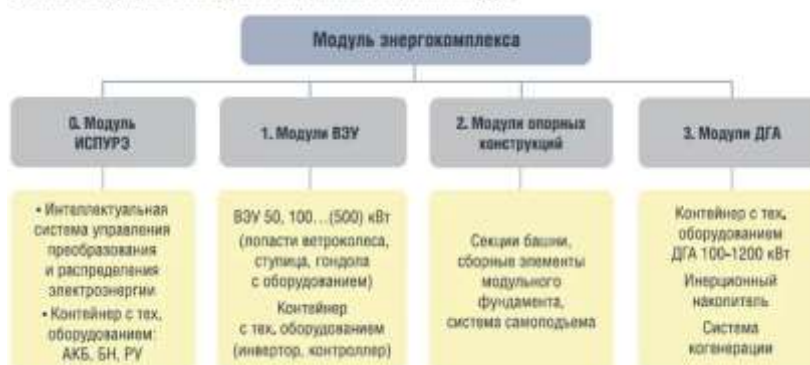
РИСУНОК 2. Структурная схема модульного ветродизельного энергокомплекса (ВДЭК)
